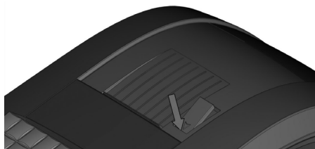
Obrázek 2.6 – Zavedení papírové pásky do tiskárny
