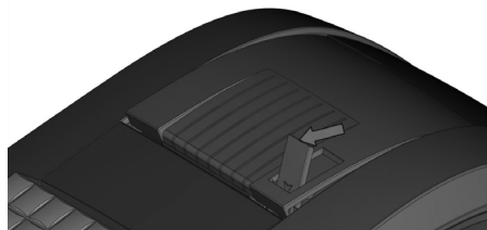
Obrázek 2.6 – Zavedení papírové pásky do tiskárny
